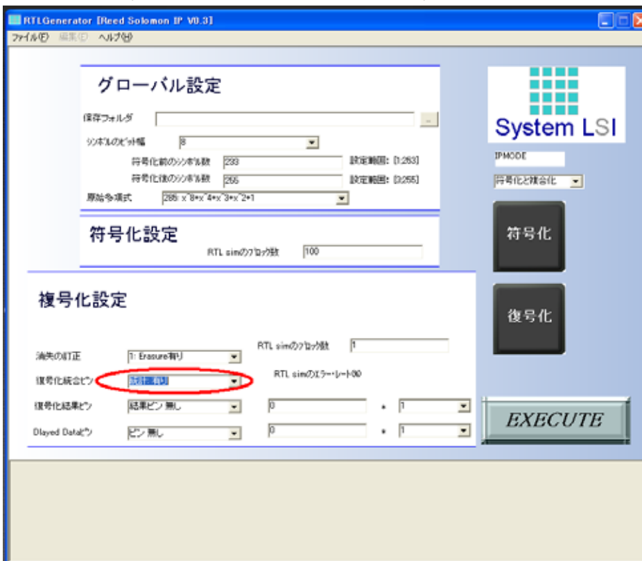
図 1 - 11 : 復号化統計選択画面 復号化結果ピンを選択します。ここでは“有”を選択します。
